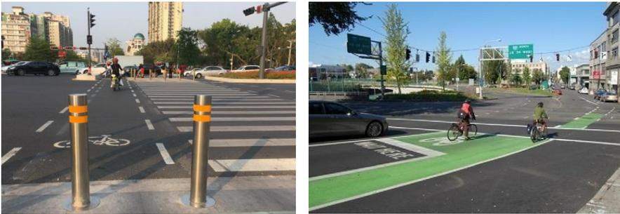
图 6-2 人非分离式过街斑马线 图 6-3 波特兰非机动车通行空间设计
