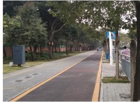
图 2-2 标线隔离非机动车道 图 2-3 特殊铺装人非共板型
