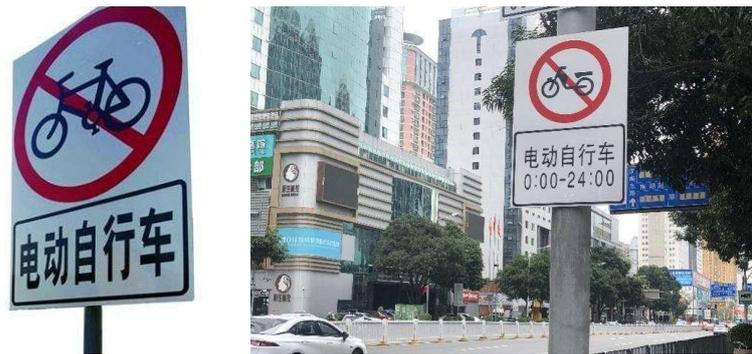
图 6-8 禁止电动二轮车进入标志示例
