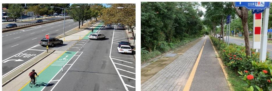
图 2-2 标线隔离非机动车道
